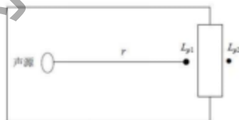
图 4-2 室内声源等效为室外声源图例
