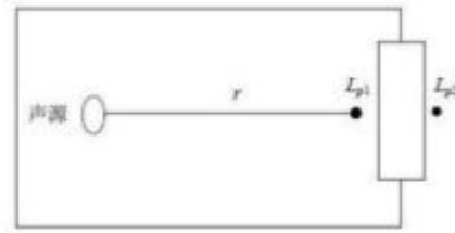
图4-1室内声源等效为室外声源图例
