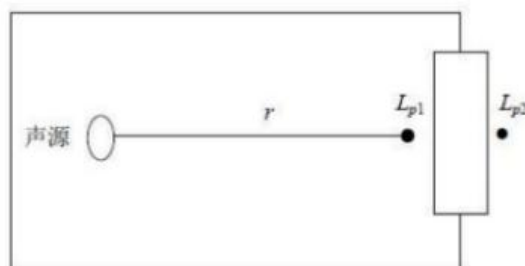
图 4-3 室内声源等效为室外声源图例
