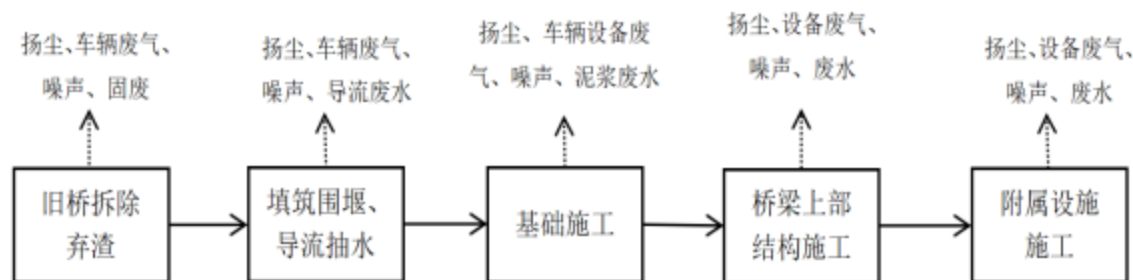
图 2-3 桥梁工程施工方案及产污位置图
